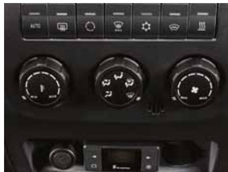
Unidad de control del sistema de aire acondicionado y calefacción
